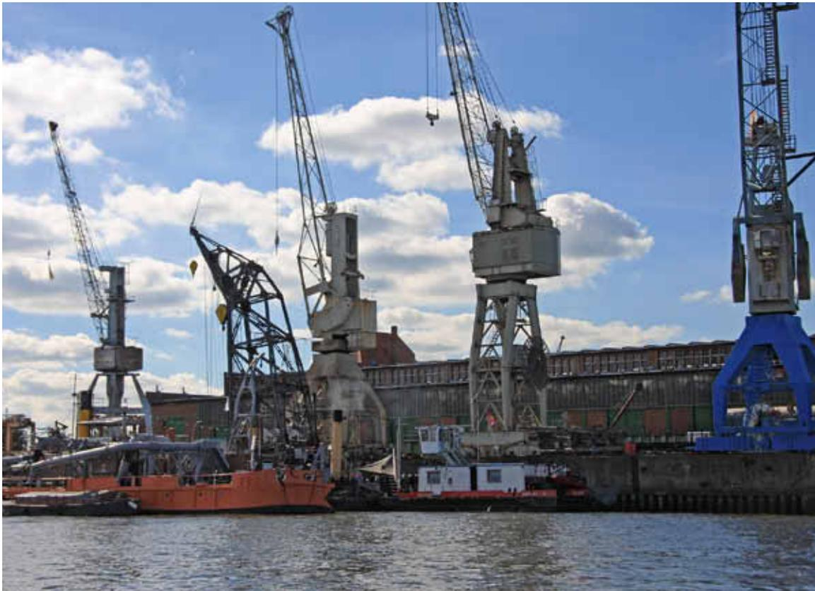
Technische Großobjekte am Bremer Kai: Vollportalkrane, Schwimmkran SAATSEE, Schutendampfsauger IV und Schute
