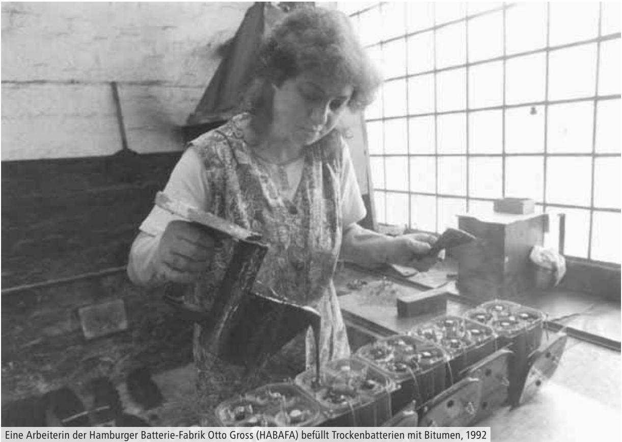
Eine Arbeiterin der Hamburger Batterie-Fabrik Otto Gross (HABAFA) befüllt Trockenbatterien mit Bitumen, 1992
