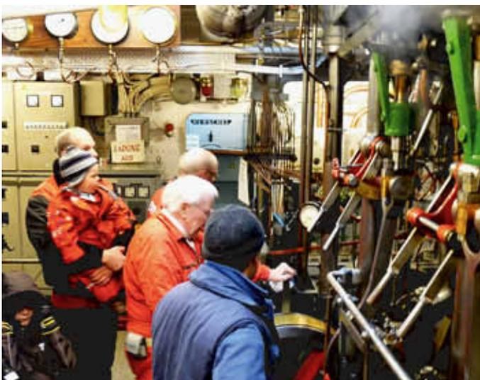
Dampfvorführung auf dem Schutensauger IV zum Antrieb von Förder- und Wasserpumpe mit 720 PS
